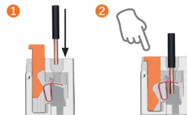
Abisolierten Leiter bis zum Anschlag in die Kontaktkammer stecken
