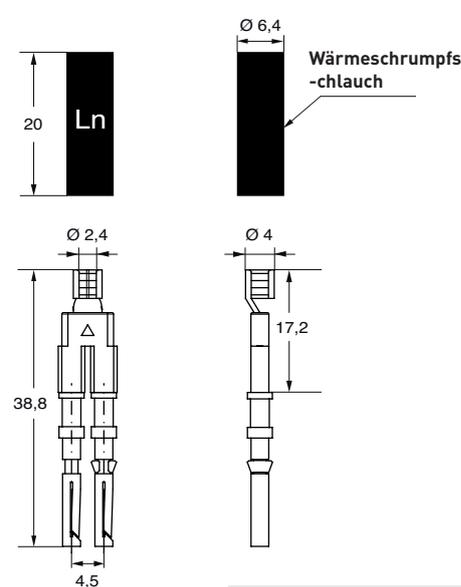
Für Leiterquerschnitte von 1,5 bis 2,5 mm<sup>2</sup> (AWG 16 – 14), Crimpverbindung mit Zange CRPZ (Modell CEMBRE IDT) und Presseinsatz CRD.
