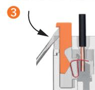
Stecken Sie einen normalen Schraubendreher  $0,5 \times 3,5 \text{ (mm)}$  in die seitliche Öffnung des Verriegelungselements und heben Sie es durch eine Schwenkbewegung an.
