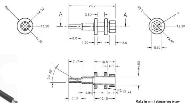
**GOGAPLUG Zugentlastungsklemme für Miniatur, Standard und Duplex Thermoelement Steckverbinder / cable/wire clamps for miniature, standard and duplex thermocouple connectors**
