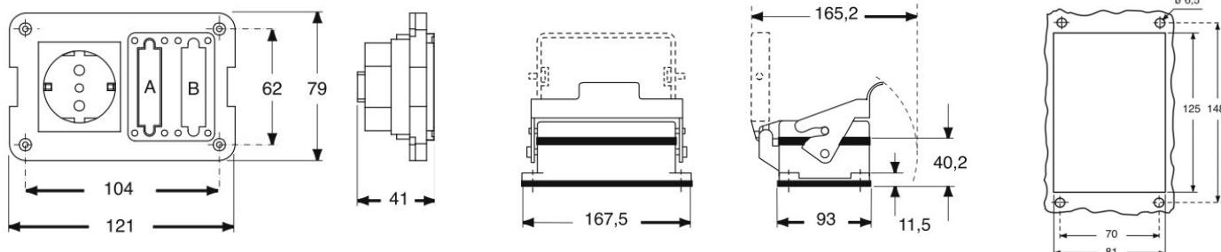
Ausbrechbarer Platz „A“ für zweiten D-SUB Adapter, wenn benötigt. Adapterplatten CR...AD bitte separat bestellen! / Breakable space "A" for second D-SUB adapter, if needed. Adapter plates CR ... AD please order separately!
