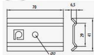
**GOGATRAY Glasfaser-Kabelabgang / fiber cable outlet**
