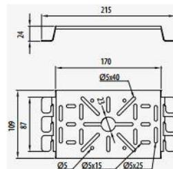
**GOGATRAY Flanschplatte f. Schlauchverschraubung / flange for hose gland**
