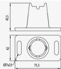
**GOGATRAY Bodenbefestigung Metall / floor fixing metal**
