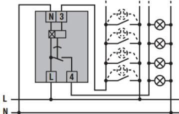
**Anschluss 3 Drähte / connection 3 wires**
