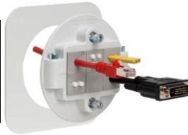
Die geteilte Kabelverschraubung KVT-SNAP ermöglicht die Einführung von konfektionierten Leitungen oder fertigen Kabelsätzen. Somit können konfektionierte Leitungen schrauben- oder werkzeugfrei durch dicke Wandungen (>5 mm), z.B.: in Gussgehäuse eingeführt werden. /
