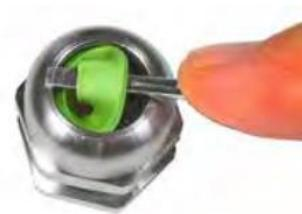
**Dichteinsatz mit leicht entfernbarem Innenring zur schnellen Anpassung auf größeren Kabeldurchmesser / sealing insert with easy-to-removed inner ring for rapid adjustment to larger cable diameter**
