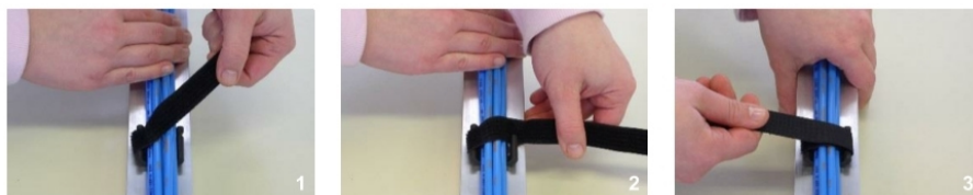
Bündelung: Bündel einlegen (1) – Spannen & Rückführen (2) – Fixieren (3)
