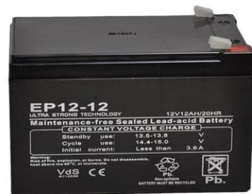
Bei der EKO-Power Serie handelt es sich um ventilgeregelte- (VRLA) Batterien in wartungsfreier AGM- Ausführung. Durch die innovative Vliestechnologie zeichnet sich die EKO- Power Serie in ihrer Kompaktheit, Sicherheit, Wartungsfreiheit und Leistung aus. Die Vds- zertifizierten Modelle wurden speziell für "Standby" Applikationen entwickelt. Ihre Verwendung finden sie vorwiegend in USV- Anlagen, Sicherheitstechnik und im Telekommunikationsbereich. /
