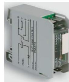
Induktive Lasten müssen mit einem geeigneten Entstörglied beschaltet sein. Nach einmaliger Benutzung des Bausteins über der Leistungsgrenze der Hartvergoldung kann der Baustein nicht mehr im Schaltbereich unterhalb der Leistungsgrenze eingesetzt werden.
