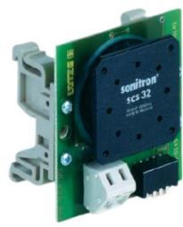
**Über einen Widerstand kann die Lautstärke reduziert werden (0-5kΩ) / the volume can be reduced with a resistor**
