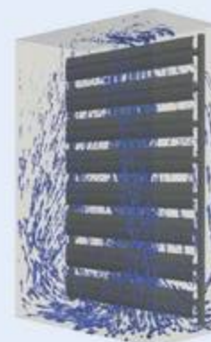
Zirkulationsströmung um AirSTREAM-Rahmen mit eingesetztem AirBLOWER-Lüftersystem
