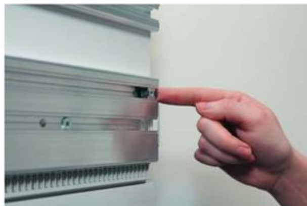
Schritt 2: Die Gleitmutterkäfige verhindern das einfache Herausrutschen der Gleitmutter. Gleitmutter in beiden Nuten platzieren.
