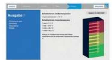
4. Schritt: Berechnung und differenzierte Darstellung der Schaltschrankinnentemperatur
