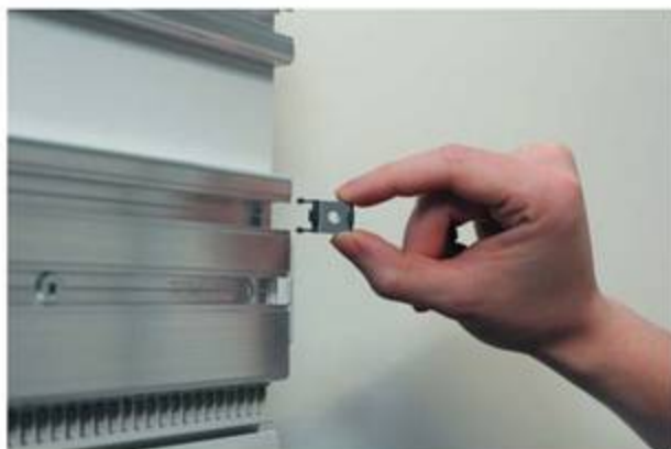
Schritt 1: Gleitmuttersteine (mit Gewinde M3-M8) können mit einem Gleitmutterkäfig einfach in den Gleitmutterkanal eingeführt werden.
