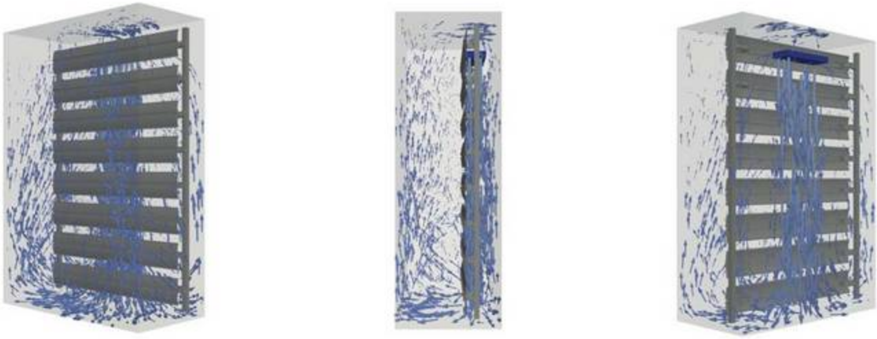
Abbildung 1: Zirkulationsströmung um AirSTREAM-Rahmen mit eingesetztem AirBLOWER-Lüftersystem
