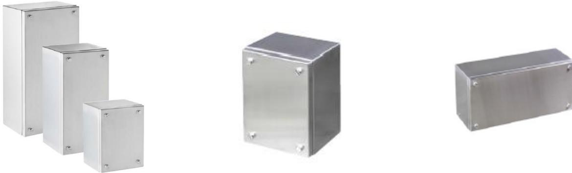
**Standard:** Gehäuse aus Edelstahl AISI 304L und AISI 316L mit glatten Seiten und verschraubter Abdeckung mit verfügbaren Tiefen von 95 und 135 mm / stainless steel boxes AISI 304L and AISI 316L with plain sides and screw-on cover with depths of 95 mm and 135 mm.
