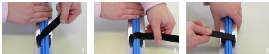
Bündelung: Bündel einlegen (1) – Spannen & Rückführen (2) – Fixieren (3)
