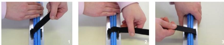
Bündelung: Bündel einlegen (1) – Spannen & Rückführen (2) – Fixieren (3)
