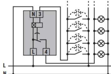
Anschluss 3 Drähte / *connection 3 wires*
