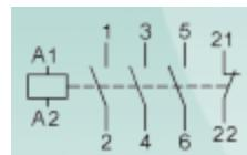
230 V AC-Spule / AC-coil
