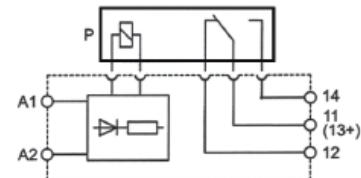
**Die Sockel für 230 V und 115 V haben einen Spannungsteiler eingebaut! Um einen Relaisbaustein mit Eingangsspannung 230 VADC oder 115 VADC zu erreichen, wird das 60 V - Relais in die Sockel für 230 V oder 115 V eingesteckt. / The sockets for 230 V and 115 V have an installed voltage divider!**
