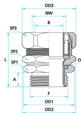
**GOGACON M6-D drehbare Schlauchverschraubung PG /**
